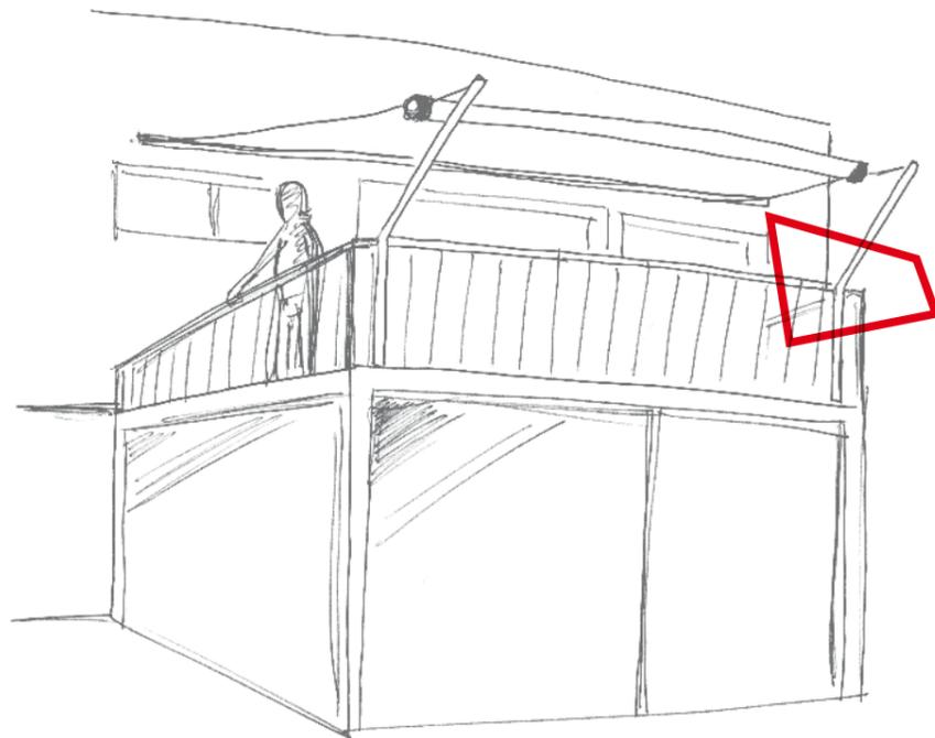
Durch gekröpfte Stützen kann die Ausladung bei Geländeranwendungen nochmals vergrößert werden. Diese sind als Sonderanfertigung erhältlich.
