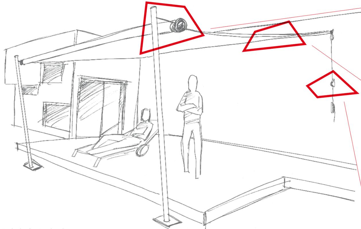
Flexibel gelagerte Tuchwelle. Spannseile und Tuch bleiben in jeder Ausfahrposition gespannt.
